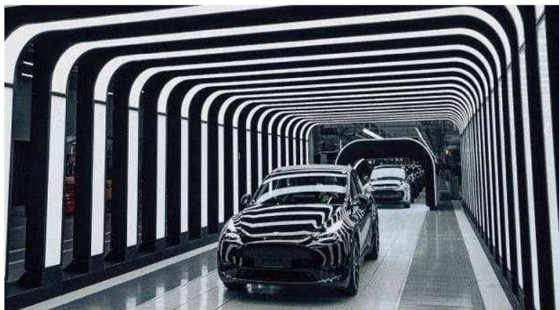
Figura 11: Típico túnel de luz para avaliação da qualidade da superfície ( detailing light tunnel ). (adaptado de [CarDesign, 2023])
